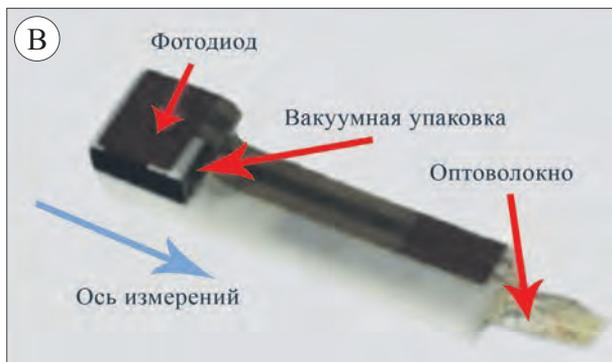
*Атомный магнитометр с волоконно-оптической связью в масштабе микросхемы:*
