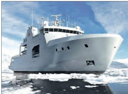
«Фредерик Ролетт» спустили на воду в сентябре 2023-го. Длина корпуса корабля составляет 103 м, водоизмещение 6 615 т, скорость до 17 уз на открытой воде и 3 уз – при движении через льды толщиной 1 м. Дальность плавания 6 800 морских миль, автономность 85 сут, экипаж 65 человек
